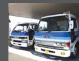
給水車&汚水車 機内に清水を給水するトラックと客室内の汚水を処理するトラック。 给水和污水车 一种给机内供应清水的卡车和处理客舱内污水的卡车。
