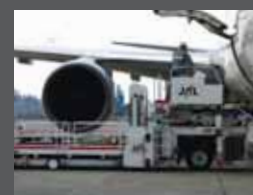
ハイリフトローダー コンテナなどを機体へ搭載降載するためのリフトが付いた専用車両。 増升装运车 用于将集装箱等装卸到飞机上的一种附带升降系统的专用车辆。
