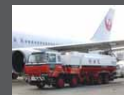
燃料給油車 (サービサー) 飛行機の燃料タンクへ給油するための車。 燃油加油车 一种用于给飞机的油箱加油的车辆。
