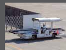
ベルトローダー 乗客の手荷物などを機内に積み込むためのベルトコンベアーを装備した車。 带式装载机 用于将乘客行李等装入机内的一种装备有带式输送机的车辆。
