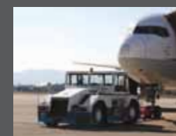
トローイングカー 自力ではバックできない飛行機を移動させるための牽引車両。 牵引车和货箱运输车 用于移动不能自行后退飞机的牵引车辆。
